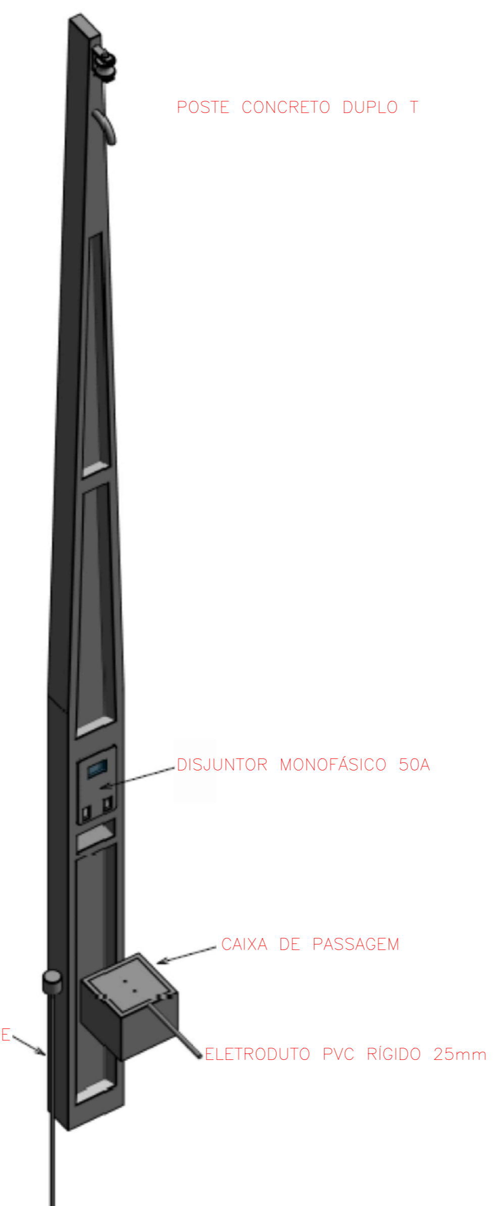
2 DETALHE DO MEDIDOR SEM ESCALA
